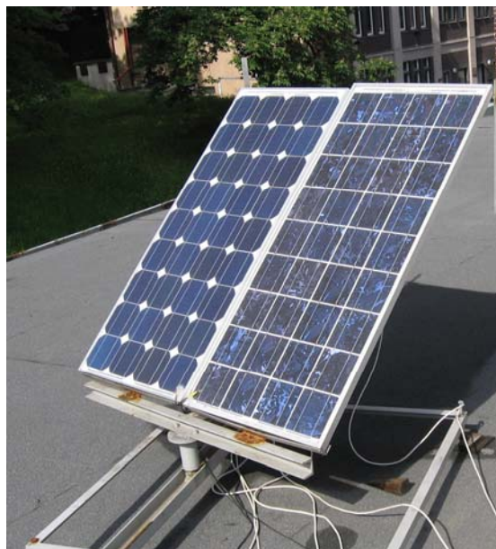
Instalacja PV z systemem nadążnym i całorocznym monitoringiem
