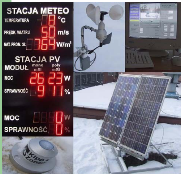
Instalacja PV z systemem nadążnym i całorocznym monitoringiem
